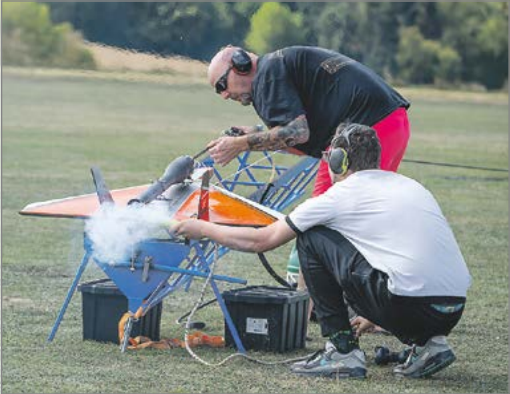
Publikumslieblinge: Die Pulsoflieger aus den Niederlanden verwenden Deltas, dreieckige Flugzeuge, die auf dem Rücken das Pulsrohr mitsamt Brennkammer tragen. Das Foto zeigt Jinx de Vries beim Starten des Pulsrohrs. Foto: Klaus Sauerteig
