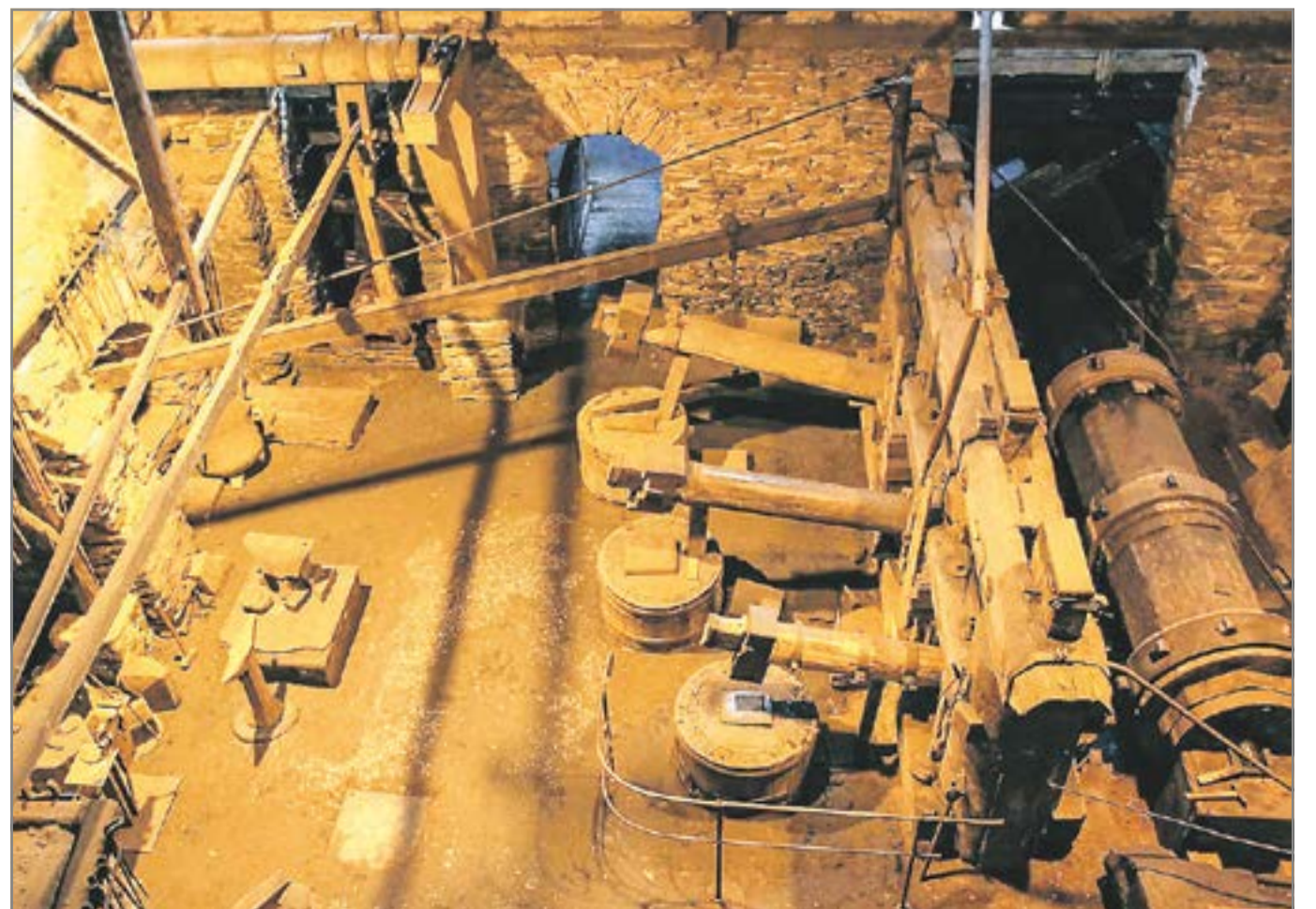
Bewegt durch Wasserkraft: Drei unterschiedlich große Schwanzhämmer in der Hammermühle formten Roheisen um zu handelsfähigem Eisen. Dazu zeigt Reinhold Reinmüller in seinem Vortrag am 1. Dezember auch eine kurze Filmsequenz. Foto: Archiv Museum OR
