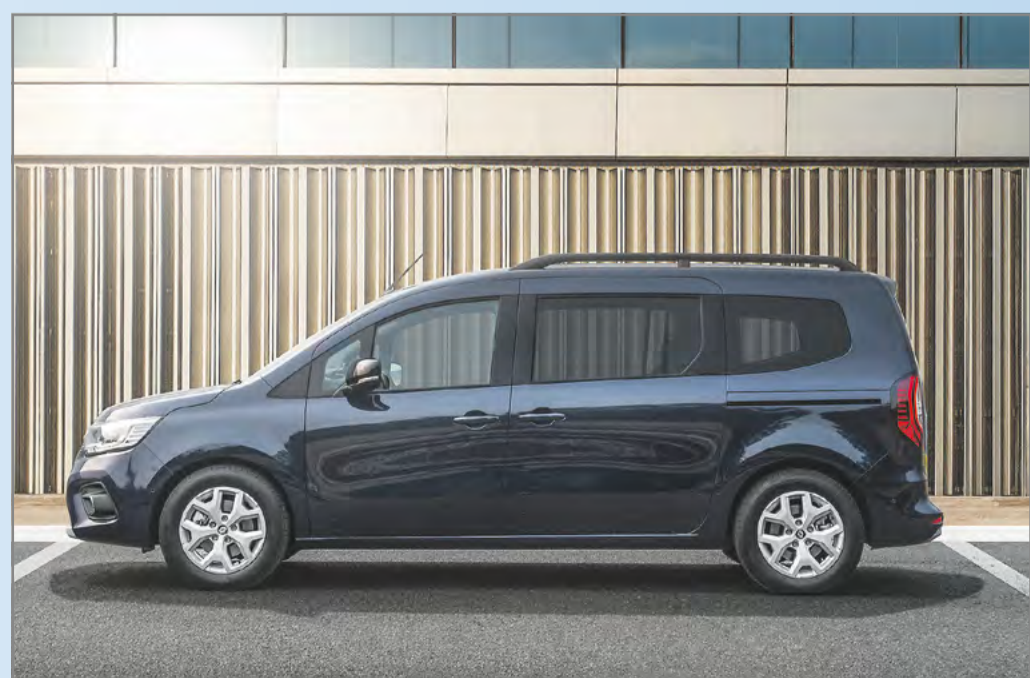
Neuer Rekord für Ladevolumen: Dieses liegt in der siebensitzigen Version von Grand Kangoo und Grand Kangoo E-Tech Electric bei 500 Litern. Werden die Rücksitze ausgebaut und der Beifahrersitz umgeklappt, steigt es auf 3.750 Liter bei einer Ladelänge von 3,11 Metern. Foto: https://presse.renault.de
