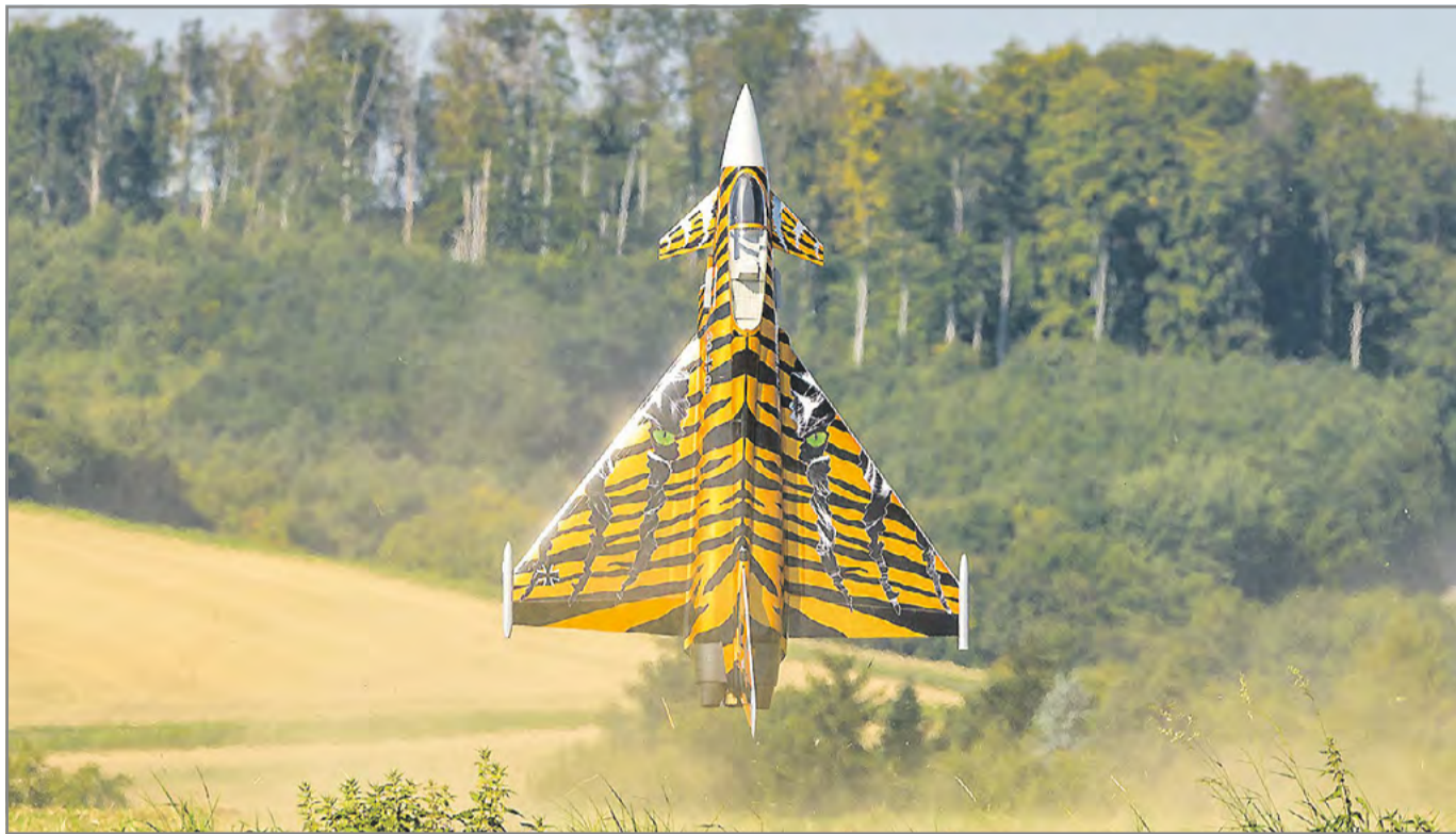
Senkrecht in der Luft: Thomas Singer wirbelt mit seinem „Eurosport“ Staub auf. 22 Kilogramm Schub bei 19,4 Kilogramm Gewicht machen das möglich. Foto: Klaus Sauerteig
