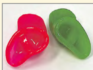
Gehörschutz aus den 3D Drucker: Wie komplex ein mit 3D-Technik produzierter Gehörschutz sein kann, zeigt das direkt im 3D Drucker entstandene Bild oben rechts. Das Endergebnis sind die farbigen Elemente (Bild links)
