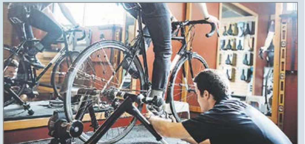
Perfekt angepasst: Das Rad besitzt die Kontaktstellen Hintern/Sitz, Hände/Griff und Füße/Pedale. Alle drei sollten beim Bikefitting an den Menschen und seine anatomischen Gegebenheiten angepasst werden. Foto: DJD/www.die-sattelkompetenz.de/Getty Images/RyanJLane
